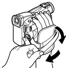
右手で本体を持ちながら、親指でスタート/ストップボタン、人差し指でズームレバーが操作できるように、手の位置を決め、ベルトの長さを調整します。
