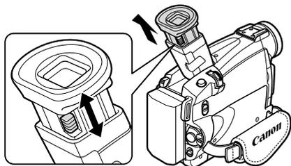
電源を入れ、ファインダーを止まるところまでまっすぐ引き出します。ファインダー内の表示がはっきり見えるように、視度調整レバーを動かして調整します。
