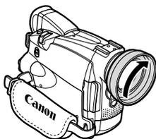
WA-30.5を、ビデオカメラのフィルター取り付けねじに完全にねじ込みます。
