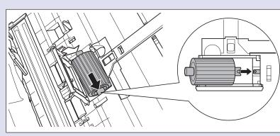
8. ローラー固定レバーを右方向にスライドさせ、フィードローラーの左側の穴にはめ 込み(①)、ローラー固定レバーを倒してフィードローラーの軸を固定します(②)。
