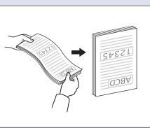
4. 原稿のうら面を手前に向け、原稿の上側を下に向けてセットし、原稿ガイドを原稿 の幅に合わせます。
