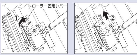
7. フィードローラーをセットし、ローラーの切り欠き部を本体側の軸に合わせます。
