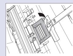
**10.** 前ユニットの左右を静かに押して、前ユニットを閉じます。このとき、カチッと音が して確実に閉じたことを確認します。
