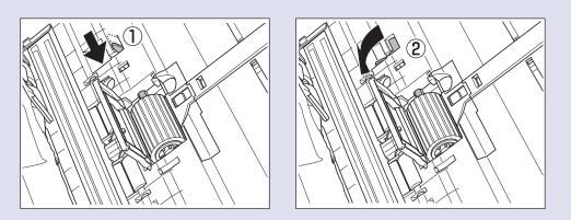
**9.** ローラーカバーを閉じます。このとき、カチッと音がして確実に閉じたことを確認 します。
