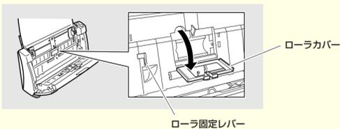
5. ローラ固定レバーを起し（①）、左方向へスライドさせます（②）。
