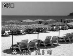
**3** コントローラーホイールを回して、シャッタースピードと絞り数値の組み合わせを変える
