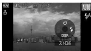
撮影モードでは、コントローラーホイールに指をのせると、指をのせたホイールの位置に割り当てられた機能が表示されます。また、再生モードに切り換えると、再生モードのときに割り当てられている機能が数秒間表示されます。
