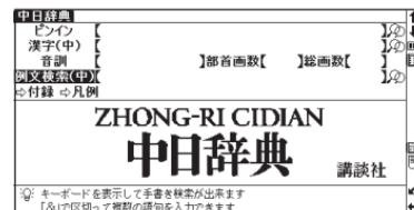
2 例文検索欄に文字入力キーを使って漢字を入力します（ここでは「shuāng」と入力します）。画面に該当する漢字が候補表示されます。Ⓐ／Ⓑでカーソルを移動させ、入力したい漢字を選択します（ここでは「【双】 shuāng」を選択します）。
