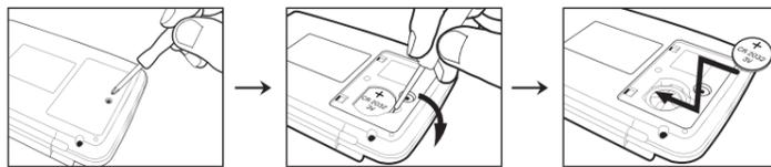
1. 電池ぶたの止めネジを外し、電池ぶたを取り外します。
