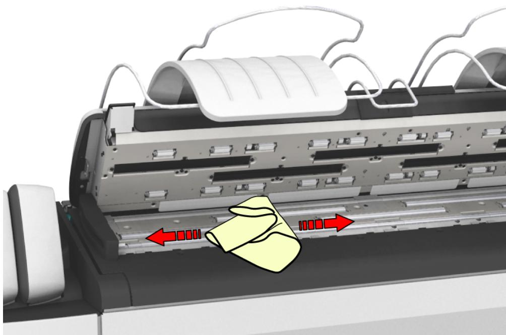
3. 乾いたモスリンタオルを使用して、クリーニング済みの各部をから拭きします。
