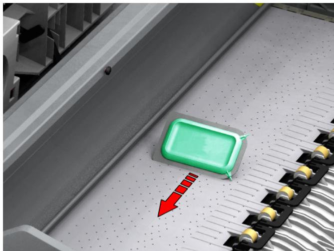
5. プリント面の穴が開いていない場合は、クリーンカードのピンを使って穴を開けてください。
