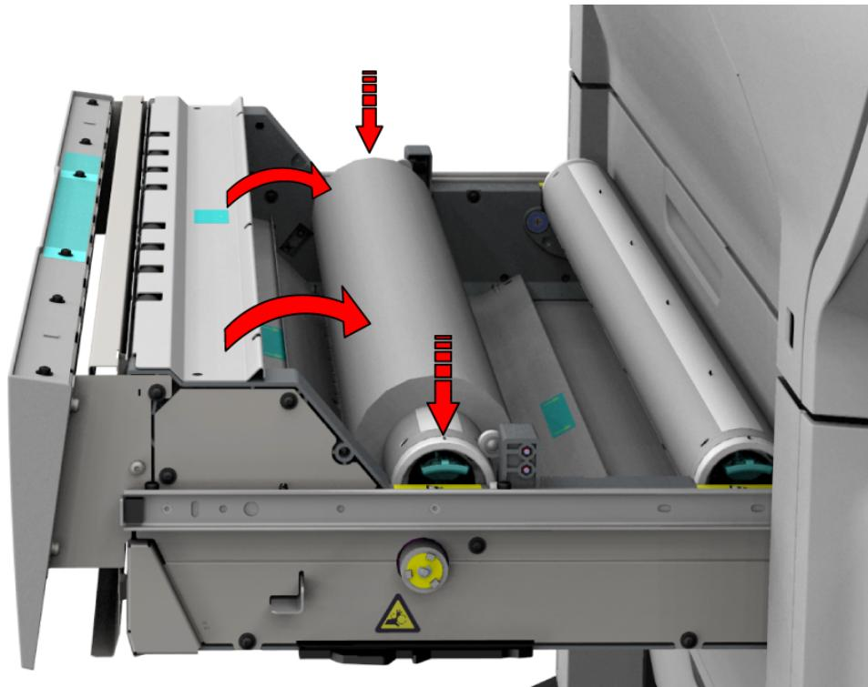
6. 両手を使用して、用紙のフラップが金属製の用紙ガイドを通り過ぎるまで、ロール紙を巻き戻します(1)。
