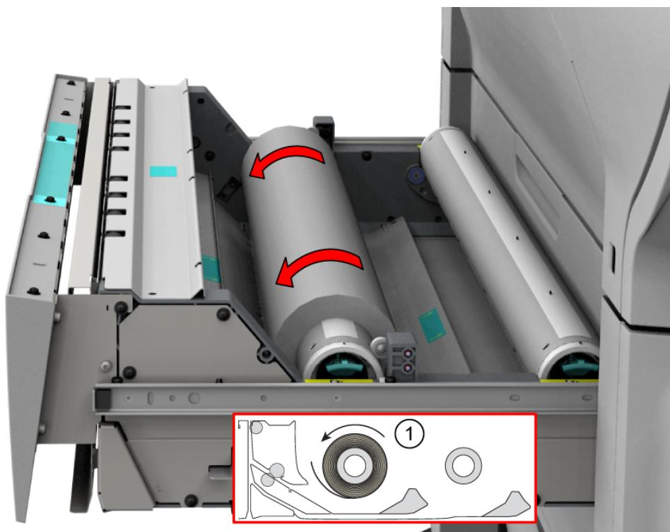
3. 図に示すように両手を使用して、ロール紙とロール紙ホルダーを持ち上げ、ロール ローディング ステーションに置きます。
