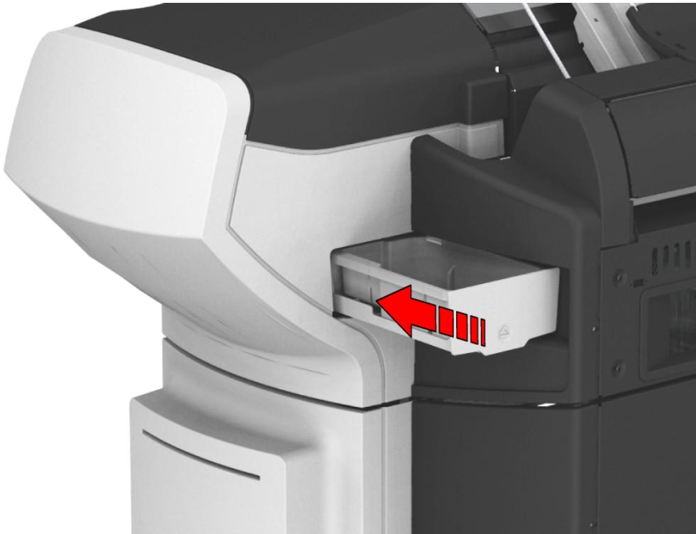
7. 新しいメンテナンス トレイを適切に取り付けたら、ウィザードで [OK] をタップします。古いメンテナンス トレイは、事業系一般廃棄物として処分することができます。
