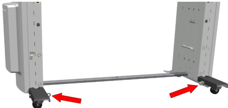
独立型プリンタは地震の際に移動する場合があり、それにより人が負傷したり、出口が塞がれたりします。用意された耐震対策リングを用いて、プリンタを取り付けて、プリンタを最初に設置した場所に安全に固定することができます。
