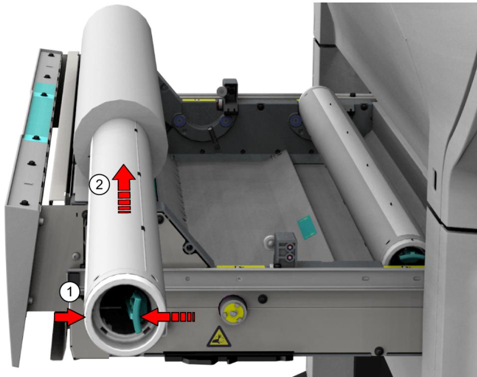
4. ロール紙ホルダーの適切なサイズインジケータの中央にロールの位置を合わせ、ロック機構のハンドルをリリースします。
