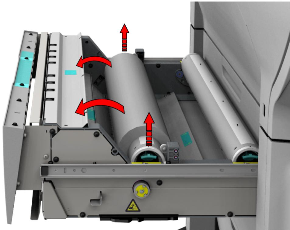
4. ロール紙ホルダーのロック メカニズムのレバーを手前に引き、ロール紙のコアからトール紙ホルダーを取り出します。
