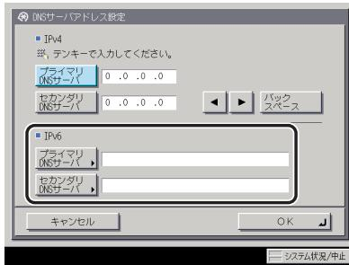
DNS の動的更新機能を使用する場合は、[プライマリ DNS サーバ] に DNS サーバの IPv6 アドレスを入力します。
