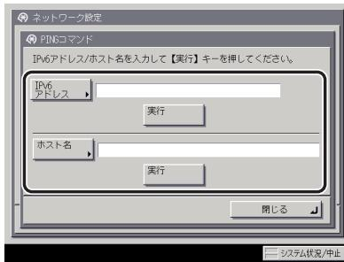
[IPv6 アドレス] にネットワーク上に存在する任意の IPv6 アドレスを入力したあと [実行] を押すと、タッチパネルディスプレイに PING コマンドの実行結果が表示されます。
