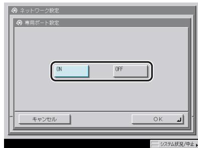
[ON]：キヤノン製のドライバやユーティリティソフトウェア (LIPS/PS プリンタドライバ、NetSpot Device Installer など) から、本製品の詳細情報の設定や参照が可能です。
