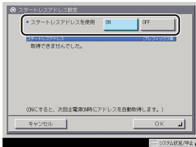
＜ステートレスアドレスを使用＞を「ON」：本製品の起動時に、ステートレスアドレスが自動的に設定されます。
