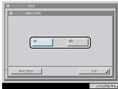
[ON]：本製品に送信した印刷ジョブを本製品のハードディスクにスプールできます。
