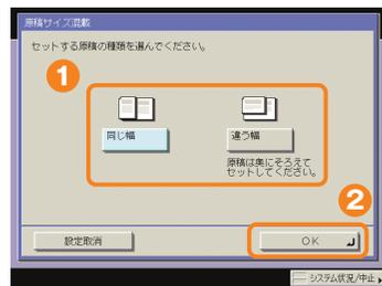
フィーダにセットする原稿に違うサイズが混ざっていても、サイズの組み合わせによっては、一度にコピーすることができます。A3とA4、B4とB5など、ヨコ方向の長さが異なるサイズの原稿や、A3とB4、A4とA5などひとまわり違うサイズの原稿を一緒にコピーできます。
