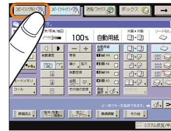
シンプル画面とクイック画面を切り替えるには、タッチパネルディスプレイ上部の【コピー（クイック）】キーと【コピー（シンプル）】キーを押します。
