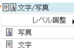
読み込んだ原稿がつぶれてしまうときには、画質選択ドロップダウンリストから原稿の種類を選択します。
