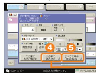
次の束を読み込むときは [次の束の読み込み設定] を押して③へ。すべての読み込み終了後 [すべての束の確認/結合] を押します。
