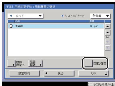
すでにプリントされた用紙のウラ面にプリントする場合は、[両面2面目] を押します。
