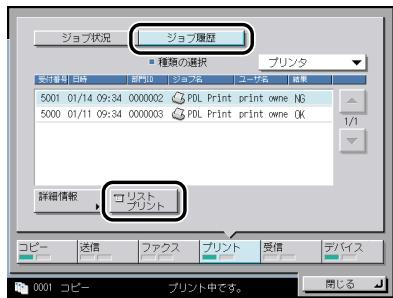
[プリント] を選択した場合は、種類の選択ドロップダウンリストを押して、ジョブの種類を選択したあと、[リストプリント] を押します。
