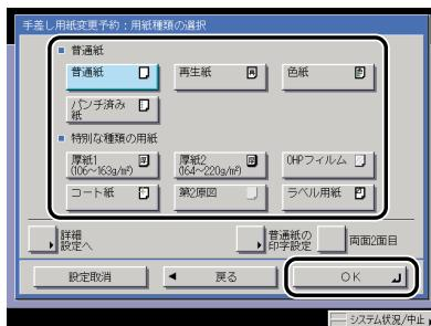
トナーの定着具合を調整する場合は、[普通紙の印字設定] を押します。トナーが定着しすぎる場合は [薄め] を、トナーの定着が悪い場合は [厚め] を押します。
