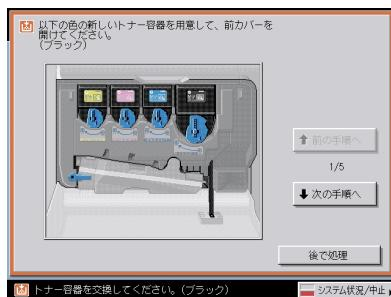
[後で処理] を押した場合は、トナーをすぐに交換しなくてもモードの設定、原稿の読み込みなどの操作は続けることができます。
