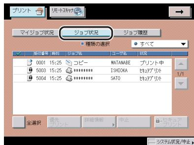
メモ ログインサービスを利用している場合は、[マイジョブ状況] が表示されます。現在ログインしているユーザのジョブのみ表示されます。
