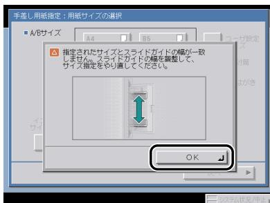
下の画面が表示されたときは、スライドガイドの幅を手差し用紙の標準モードとして登録した用紙サイズに合わせるか、共通仕様設定（初期設定／登録）で手差し用紙の標準モード登録を「OFF」にしてください。（→手差し用紙の標準モードを登録する：P.4-45）
