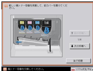
[後で処理] を押した場合は、回収トナー容器をすぐに交換しなくてもモードの設定、原稿の読み込みなどの操作は続けることができます。
