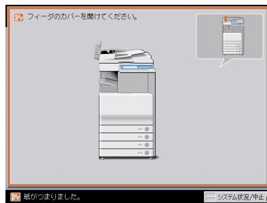
**！警告** 製品内部には、高圧になる部分があります。紙づまりの処理など内部を点検するときは、ネックレス、ブレスレットなどの金属物が製品内部に触れないように点検してください。やけどや感電の原因になることがあります。
