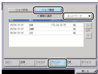
本製品がアクセスを拒否した IP アドレスからのアクセス履歴が表示されます。
