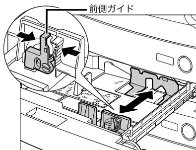
**重要** 紙づまりやプリントの汚れ、本製品内部の汚れの原因になりますので、用紙サイズの指標に必ず正しく合わせてください。
