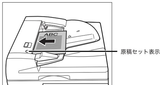
原稿をセットしたときに、原稿読み取り部が汚れている場合は、以下のような画面が表示されます。原稿読み取り部を清掃してください。[閉じる] を押して原稿の読み込みを行うこともできます。原稿読み取り部の清掃については、「フィーダを清掃する」(→ P.7-39)を参照してください。
