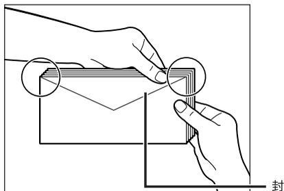
洋形 4 号の封筒を使用する場合は、封の部分は折り曲げずにセットしてください。
