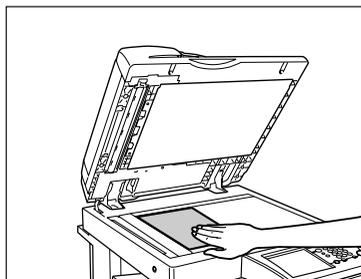
原稿は読み込む面を下向きにして、原稿台ガラス面の左奥（矢印マーク）に原稿の角を合わせてセットします。
