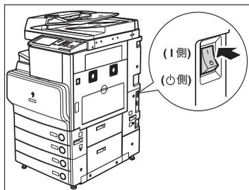
操作パネルの主電源ランプが点灯します。
