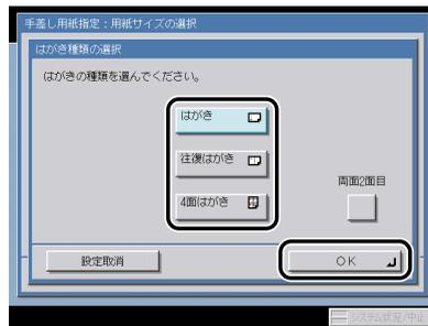
すでにプリントされた郵便はがきのウラ面にプリントする場合は、[両面 2 面目] を押します。
