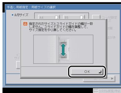
下の画面が表示されたときは、スライドガイドの幅を手差し用紙の標準モードとして登録した用紙サイズに合わせるか、共通仕様設定（初期設定/登録）で手差し用紙の標準モード登録を「OFF」にしてください。（→手差し用紙の標準モードを登録する：P.4-41）
