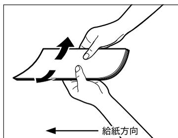
一度コピーした用紙の裏面に手差しコピーするときは、カールをなおしたあと、コピーする面を下向きにして、また、最初のコピーで前に排紙された辺が給紙方向になるように、用紙をセットしてください。
