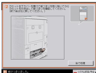
**警告** 製品内部には、高圧になる部分があります。紙づまりの処理など内部を点検するときは、ネックレス、プレスレットなどの金属物が製品内部に触れないように点検してください。やけどや感電の原因になることがあります。
