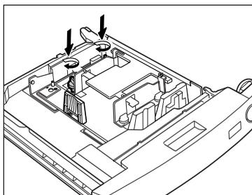
**10** 図のようにのり付け面を下にして、10枚ずつ封筒を持ち、右側から封筒受け台を押して下げるようにして封筒をセットします。
