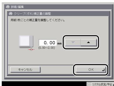
製本したときの用紙 1 枚ごとのずれ幅を用紙種類ごとに設定／変更することができます。ここで設定した値は、選択中の用紙種類を使用して製本を行う際に、[クリープ（ずれ）補正] を自動で行った場合の初期値となります。
