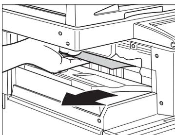
**重要** ステイプルソートを設定してプリントしていた場合、ステイプルされる前の出力中の束は取り除かないでください。(紙づまりを処理したあと、続きから出力されます。)
