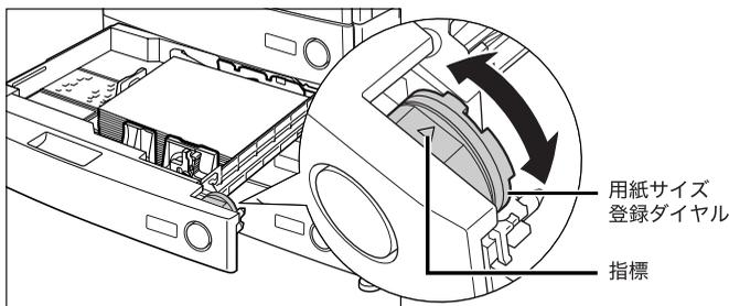
**重要** セットする用紙サイズに指標を正しく合わせないと、用紙サイズがタッチパネルディスプレイに正しく表示されません。また、紙づまりやプリントの汚れ、本製品内部の汚れの原因になりますので、必ず正しく合わせてください。
