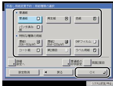
トナーの定着具合を調整する場合は、[普通紙の印字設定] を押します。トナーが定着しすぎる場合は [薄め] を、トナーの定着が悪い場合は [厚め] を押します。
