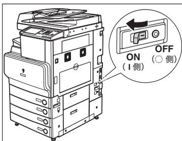
**4** 主電源スイッチを「I」側へ倒します。
