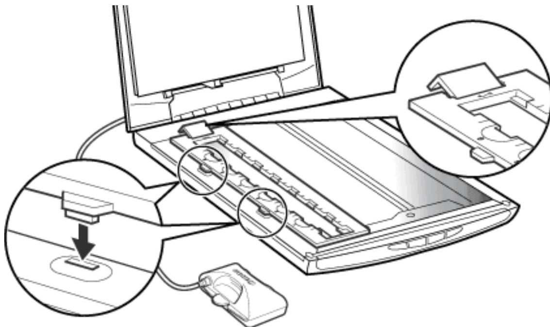
フィルムガイドの2つの爪を原稿台の穴に合わせてセットします。
