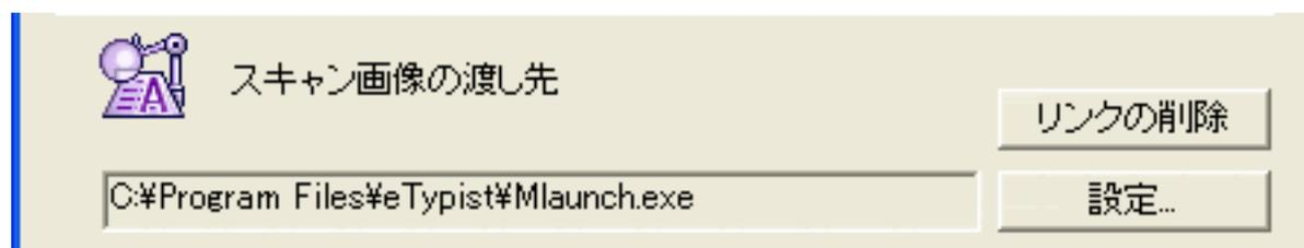
スキャンした画像の渡し先のアプリケーションソフトを設定します。枠内には現在リンク（登録）されているアプリケーションソフト名が表示されています。キヤノスキャンセットアップCD-ROMからインストールした直後には、[eTypist エントリー](#)が設定されています。
