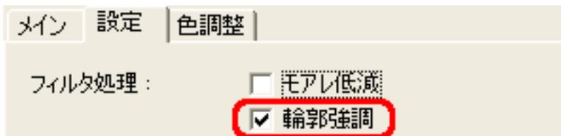
画像の輪郭を強調する機能（アンシャープマスク）を使うときは、[輪郭強調] のチェックボックスをクリックしてチェックマークを付けます（オンの状態）。ピントのあまい写真などをスキャンするときに効果的で、全体がシャープな印象の画像になります。
