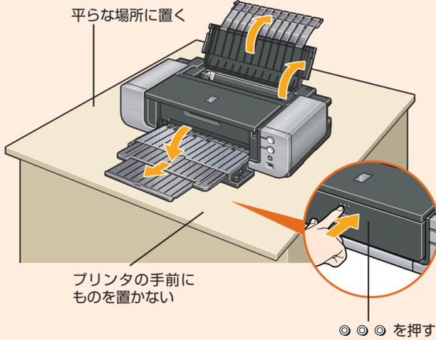
フロントトレイから給紙すると、半切サイズなどの大きな用紙や厚紙に印刷することができます。その場合は、プリンタの後方に40cmのスペースが必要です。詳しくは、「基本操作ガイド」の「フロントトレイから給紙する」(P.20)を参照してください。
