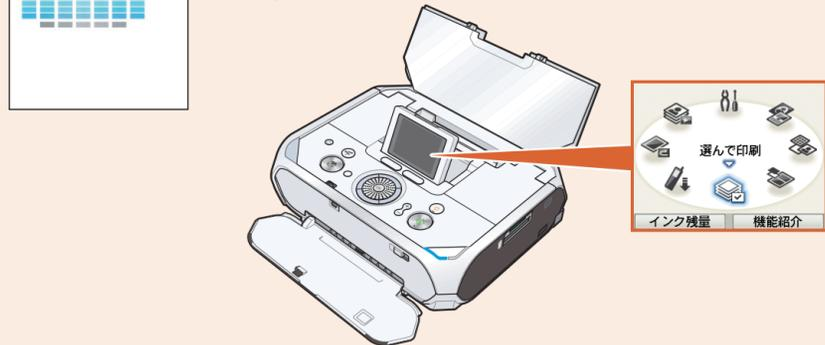
自動調整が正常に行えなかったときには、液晶モニターに「自動ヘッド位置調整に失敗しました」と表示されます。『操作ガイド』の「困ったときには」の「液晶モニターにエラーメッセージが表示されている」を参照してください。
