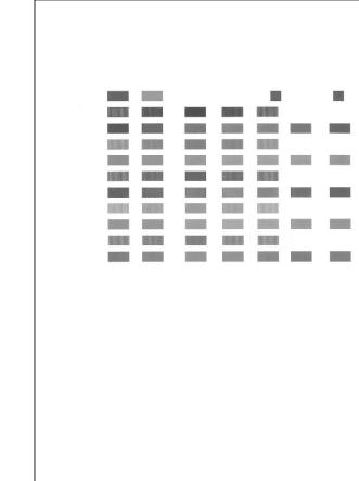
ヘッド位置調整が正しく行われなかった場合は、電源ランプがオレンジ色に11回点滅します。このような場合は、「基本操作ガイド」の「電源ランプがオレンジ色に点滅している」(P.95)を参照し、再度ヘッド位置調整を行ってください。
