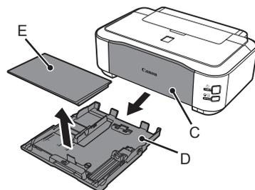
排紙トレイ (C) を閉じ、カセット (D) を手前に引き出して、カバー (E) を取り外す
