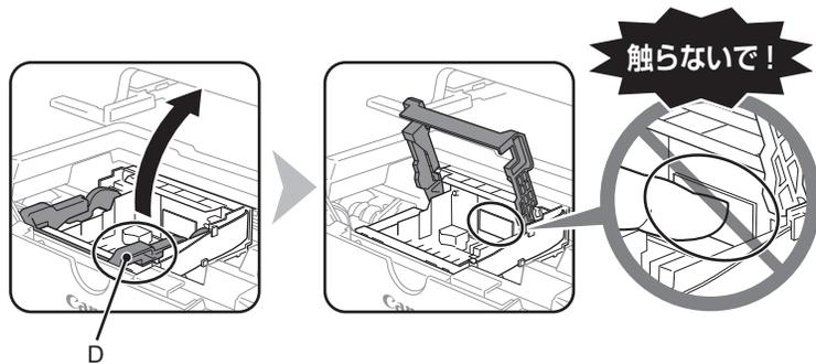
プリントヘッドホルダーの、プリントヘッド固定レバーの (D) の部分を、止まるまでしっかり持ち上げる
