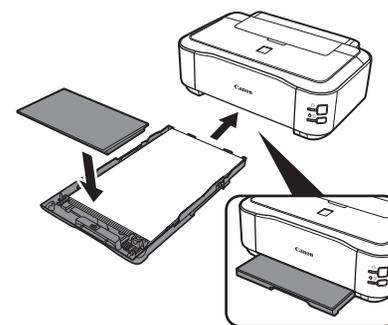
カバーを取り付けて、「カチッ」と音がするまでカセットを本製品に差し込む
