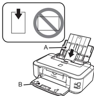
L判の写真用紙を印刷したい面を上にして、後トレイ (A) に縦にセットする (詳細は P.15 を参照)
