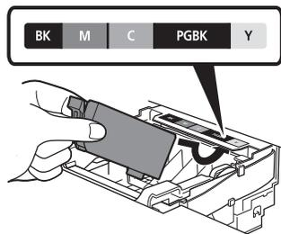
インクタンクを傾け、ラベルの下側にくぐらせて奥に差し込む
