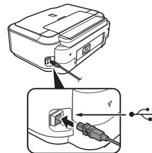
【プリンターの接続】画面が表示されたら、本製品とパソコンを USB ケーブルで接続します。
