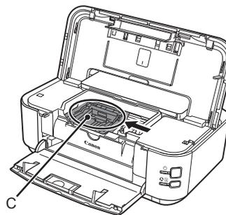
プリントヘッドホルダー (C) が取り付け位置に移動したことを確認する
