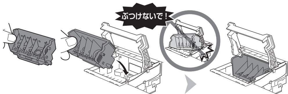
プリントヘッドを図のように手前側に傾けてセットする
