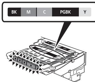
残りのインクタンクを、ラベルの色の並びどおりに同じ手順で取り付ける
