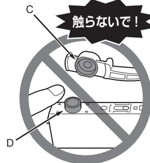
インクタンクの側面を持ちながら、オレンジ色の保護キャップを水平に90度ひねり、ゆっくり取り外す
