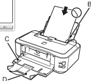
上の画面が表示されたら、「5用紙をセットしよう」手順③(P.15)以降を参照して、付属のプリントヘッド位置調整専用紙(マットフォトペーパー MP-101)を後トレイ(B)へ1枚セットし、[実行]をクリックしてください。
