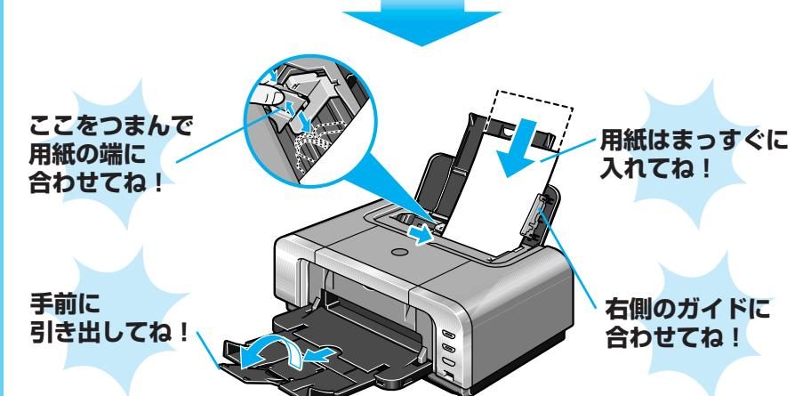
カセットからはプリントヘッドの位置調整はできません。必ず上図のようにオートシートフィーダへ用紙をセットしてください。CD-Rトレイガイドが閉じていることを確認してください。
