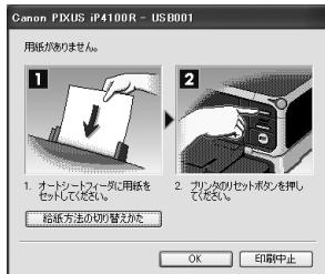
印刷中に用紙がなくなったり、紙づまりなどのトラブルが発生すると、自動的に BJ ステータスモニタが表示されます。BJ ステータスモニタが表示された場合には、[プリンタ情報] に表示されている対処方法にしたがって操作してください。
