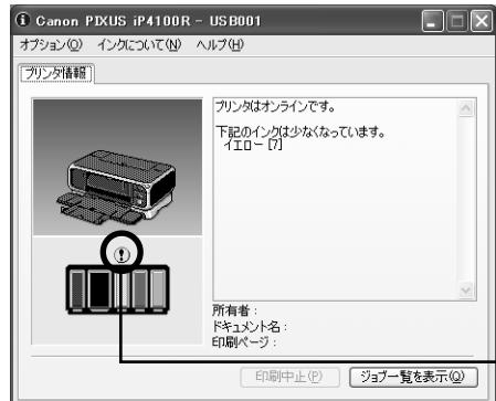
このプリンタは、2段階でインクの残量を確認できます。インク残量が少なくなると、印刷を開始したときに上記のメッセージ（インクがなくなりました）が表示される前に、BJステータスマニタ画面が表示されます。
