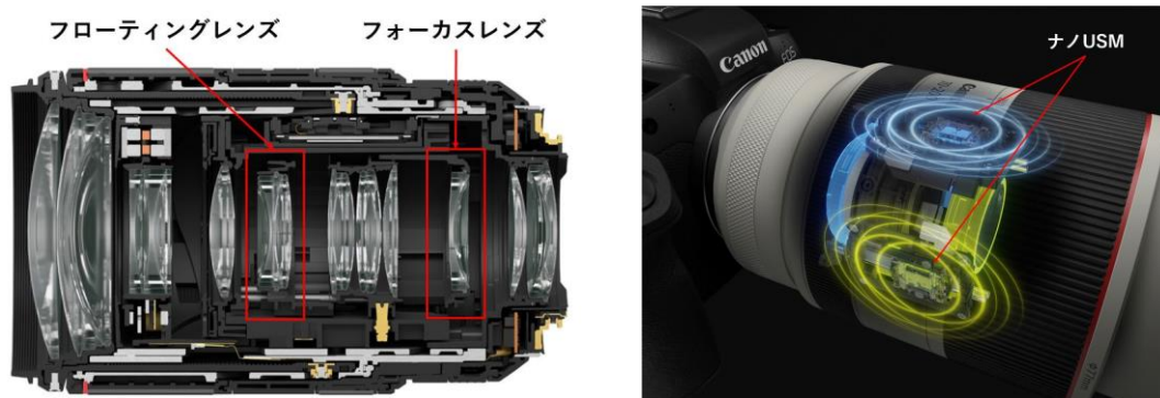
電子式フローティングフォーカス制御の「ナノ USM」配置イメージ
