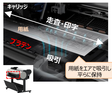
Air Feeding System イメージ
