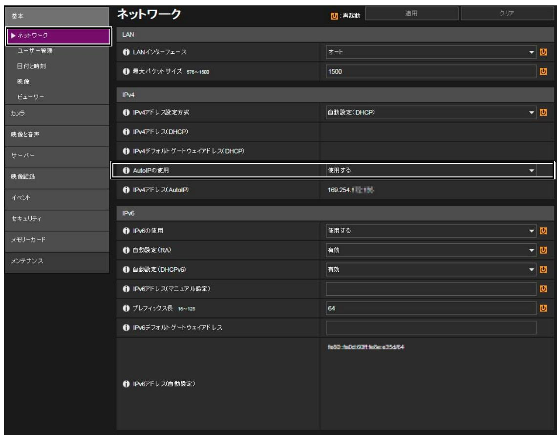
[AutoIPの使用] 工場出荷設定:[使用する]
