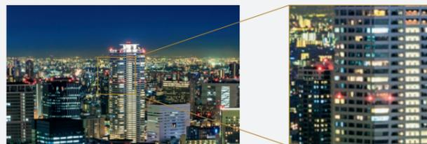
**開口率** 開口率とは、一画素あたりの面積に対して光が通過できる面積の割合。光を遮断する部分が少ないので、格子感が少ない。
