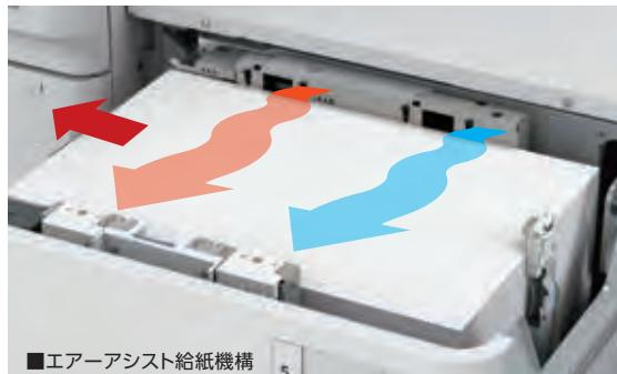
一度に複数枚給紙される「重送」を抑制するため、用紙と用紙の間に温風・冷風のエアーを吹き込み、用紙を分離させて搬送します。
