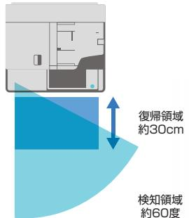
\*1 使用条件によっては検知できないことがあります。\*2 検知領域に進入すると節電スイッチが点滅して人感センサーが反応していることを示します。
