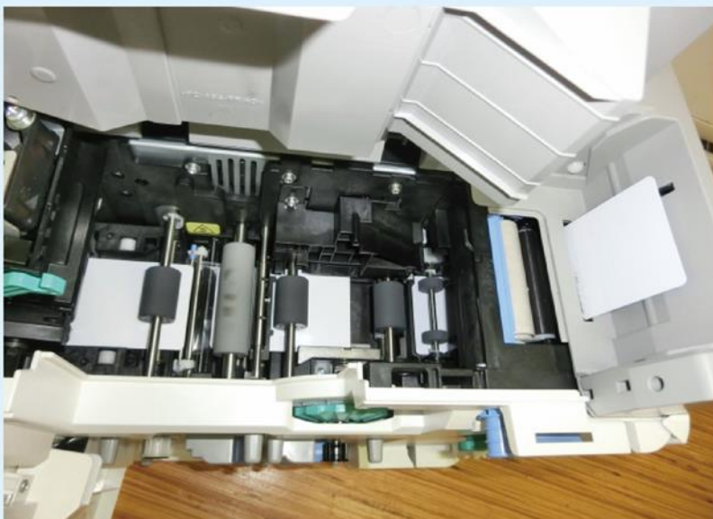
カード詰まりの際の処理、ローラークリーニングは機器上部のカバーを開けるだけ。
