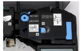
“MK5000/MK3000”は、PVC、熱収縮チューブともに、**Φ1.5mm~Φ10mm**のチューブへ印字が可能です。(チューブウォーマー使用時は、**Φ1.5mm~Φ6.5mm**。)フラットチューブは、**Φ1.5mm~Φ6.5mm**に印字可能。
