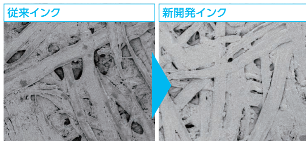
新開発インクは、従来に比べて、顔料の隙間が少なくなっています
