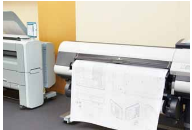
インクジェット方式の「iPF825」とトナー方式の「Oce PlotWave 360」を主なプロッターとして活用。
