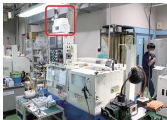
各機械の情報を収集 (枠内は社内で製作した人感センサー装置)
